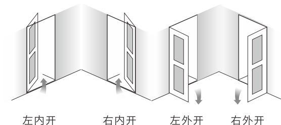
注：本智能锁适用左内开、右内开、左外开、右外开，四种开向的门。判定开门方向，人必须站在门外，正对门前。
